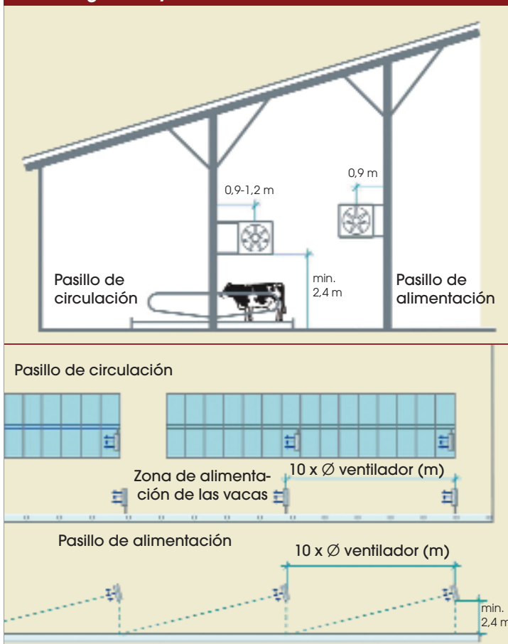
Figuras 18 y 19. Colocación de los ventiladores
