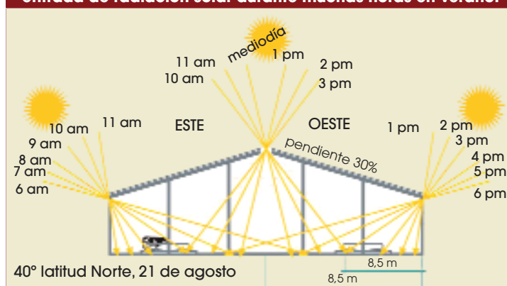
Figura 14. La orientación Norte-Sur permite una excesiva entrada de radiación solar durante muchas horas en verano.
