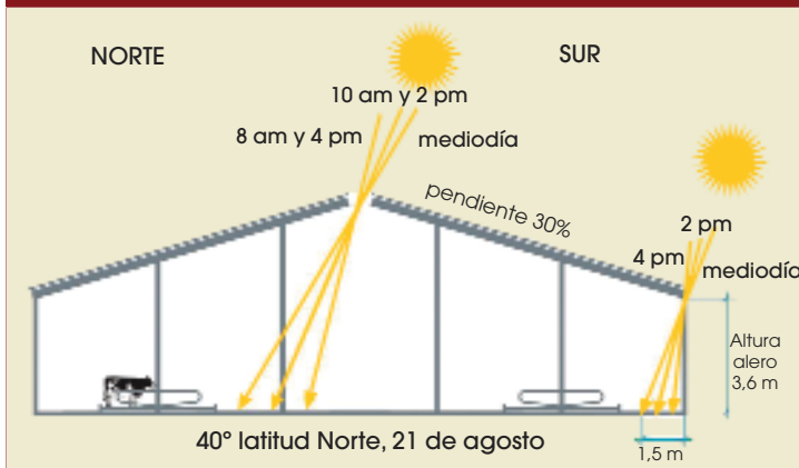
Figura 13. La orientación Este-Oeste minimiza la insolación en verano
