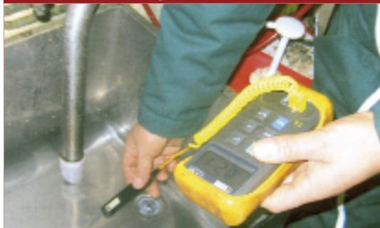
**Tiempo.** Un buen lavado se logra cuando la solución de limpieza, caliente, está el tiempo suficiente en contacto con todas las superficies que han estado en contacto con la leche durante el ordeño (tuberías, pezoneras, medidores, unidad final, etc.). Los productos que se utilizan actualmente requieren un tiempo de contacto entre 5 y 10 minutos.
