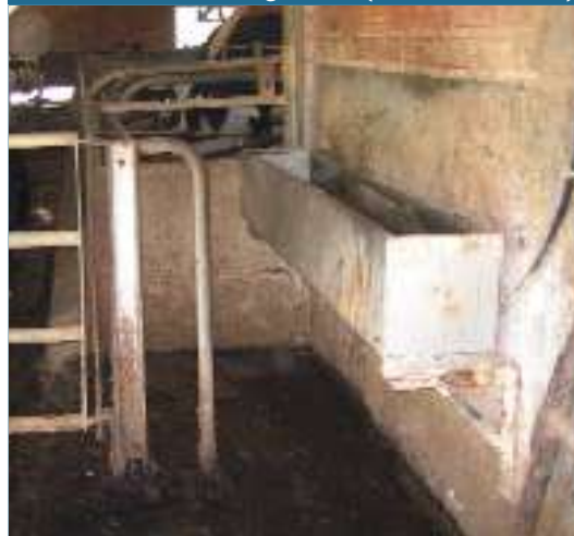
Figura 13. Abrevadero estrecho, situado muy alto y con bordes angulosos (Alboquers, 2006)
