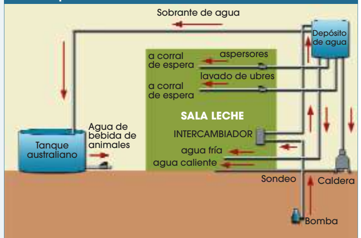
Figura 1. Esquema de posibles usos del agua recuperada del sistema de preenfriado de la leche en un intercambiador térmico
