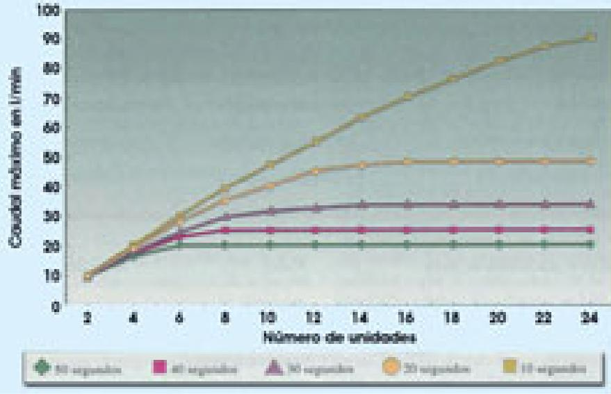
**Tabla 2. Caudal máximo de leche (l/min) por ramificación en una conducción de leche horizontal montada en anillo, correspondiente a una caída de vacío máximo de 2 kPa en las condiciones normales de ordeño, sin admisión irregular de aire.**
